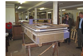
Ook de grote magazijnbalg van het orgel werd grondig gerestaureerd.
