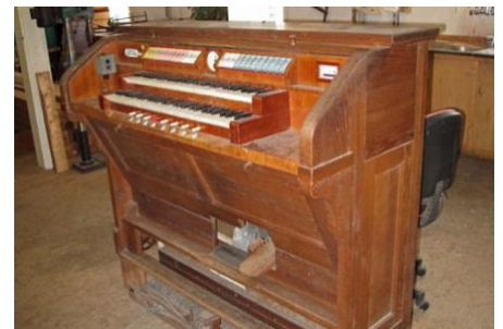
De speeltafel in de werkplaats van de orgelbouwer. De restauratie hiervan moest nog de nodige aandacht krijgen.
