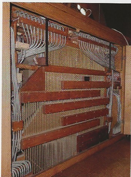
Achterzijde speeltafel met horizontaal de koppelapparaten.
