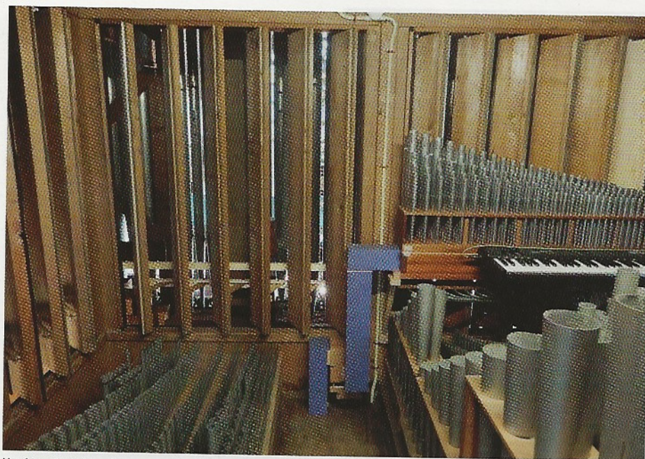
Hoofdwerk met opnieuw aangebracht zweljaloezieën en kartonnen windkanaal voor de Cornet.
